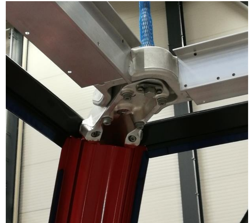
Das Eckstück wird in den Ecksäulenprofilen durch Klebverfahren verbunden
